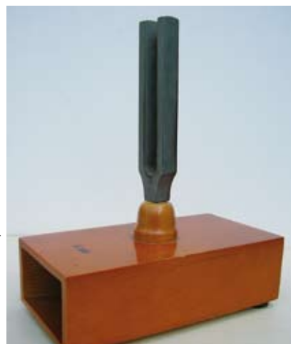
Abbildung 1: Stimmgabel mit Resonanzkasten nach Koenig
