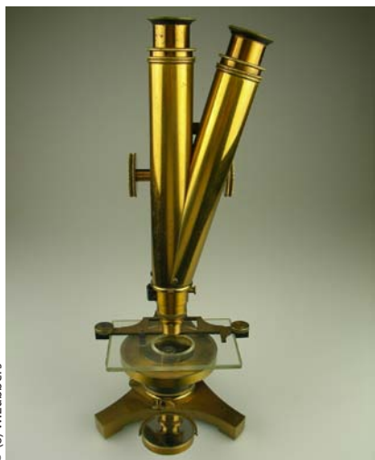
Abb. 1: Binokularmikroskop der Fa. Beck mit Wenham-Prisma, ca. 1870
