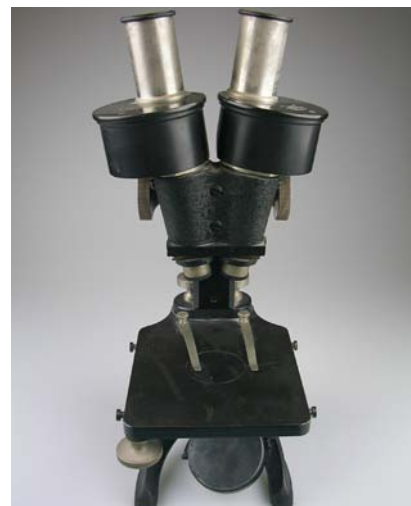
Abb. 3: Mikroskop nach Greenough der Fa. Zeiss, 1921
