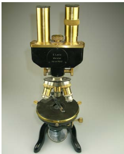
Abb. 2: Binokularmikroskop der Fa. Leitz mit Jensch-Prisma, ca. 1913
