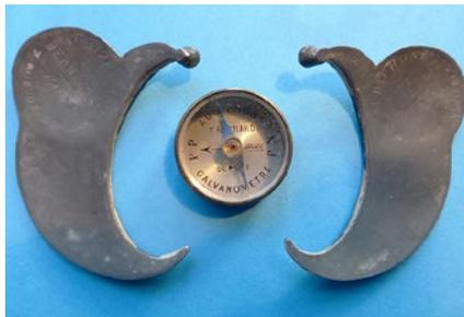
Abb. 4b: Rückseite mit Galvanometer
